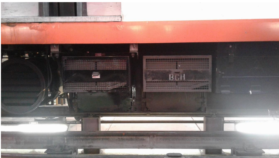
Fig. 3.7: Inductancias MLS1 y MLS2, o tanques freón, en vista lateral y bajo bastidor.
