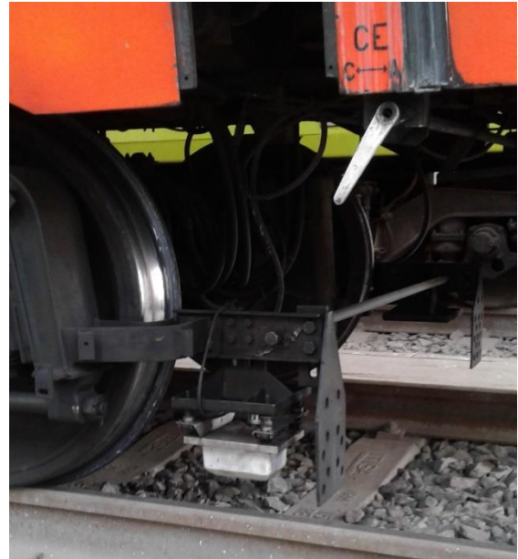
Fig. 1.26: CT (sensor de transmisión continua, detrás del barre pistas).
