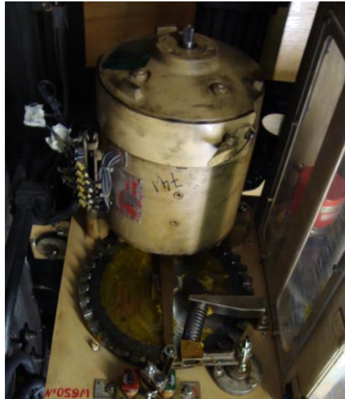
Fig. 2.9: El servomotor eléctrico que controla el combinador de arranque.
