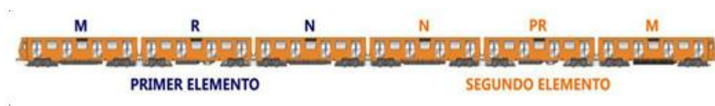
Fig. 1.23: Composición de un tren de seis carros (dos elementos).
