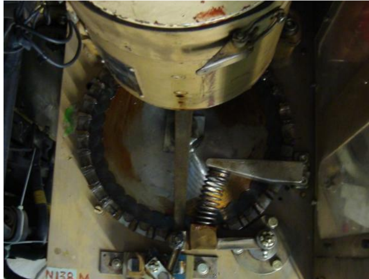
Fig. 2.3: Platillo P sobre donde se realizan las 35 posiciones del JH.
