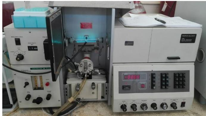
Figura 3.4. Espectrofotómetro de absorción atómica
