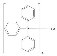
Imagen 35. Estructura del catalizador utilizado en la reacción de acoplamiento de Suzuki Miyaura. Tetrakis-(trifenilfosfina) paladio (0)
