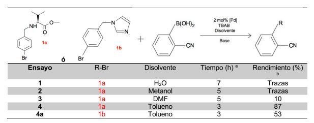
Condiciones de reacción: 0.6 mmol del ACB, 0.5 mmol de Ar-Br, 0.5 mmol TBAB, 1 mmol Na<sub>2</sub>CO<sub>3</sub>, 2% mol [Pd] y 3 ml de disolvente. <sup>a</sup> Determinado por CCF. <sup>b</sup> Porcentaje de rendimiento
