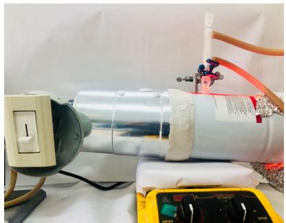
Imagen 34. Reactor de Infrarrojo fabricado en el laboratorio
