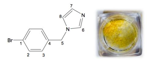
Cristales en forma de agujas amarillas, punto de fusión experimental 78-80 °C (punto de fusión reportado en la literatura 75°C) 87 % de rendimiento.
