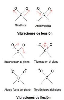
Imagen 32. Modos de vibración en moléculas: flechas indican dirección y magnitud de movimientos; signos +,indican movimientos hacia arriba y abajo perpendicular a la página.
