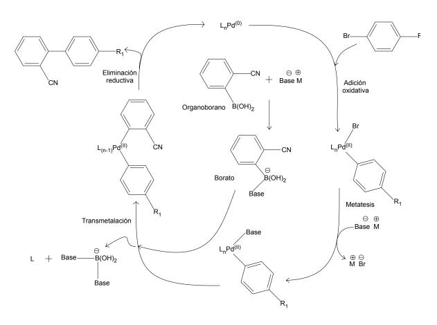
Imagen 30. Ciclo catalítico acoplamiento Suzuki-Miyaura
