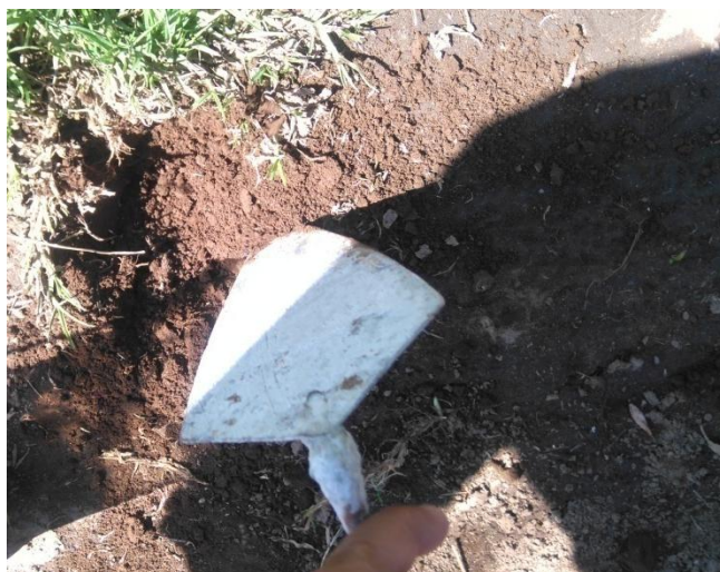
Foto 4. Apertura del suelo para introducir el anillo simple, para realizar ensayo de infiltración. Punto Dos, ubicado en el Asentamiento Xocotitla. Toma de muestra con Vegetación Media (Foto tomada por Alicia Cruz).
