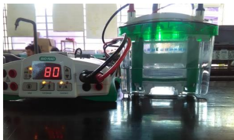
Figura 25. Instalación de la cámara electroforética y la fuente de poder.
