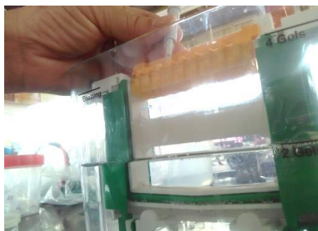
Figura 24. Colocación de las muestras en los pozos.
