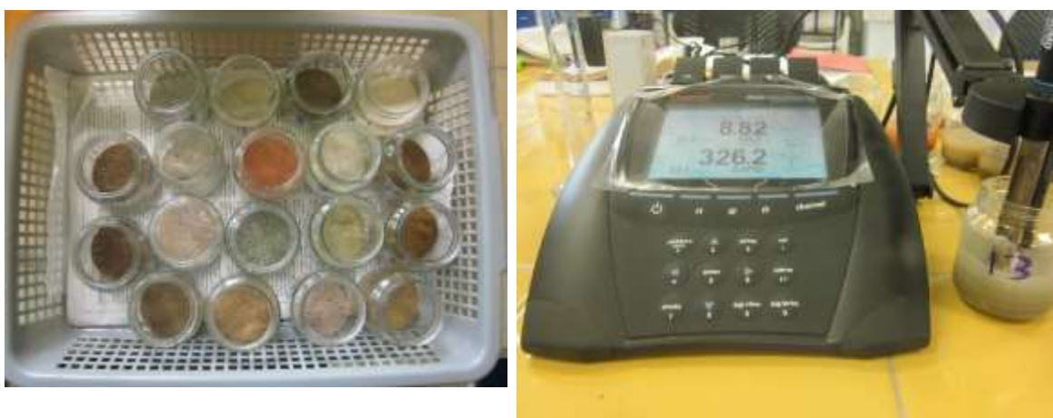
Figura 21. Procedimiento utilizado para la medición del parámetro pH
