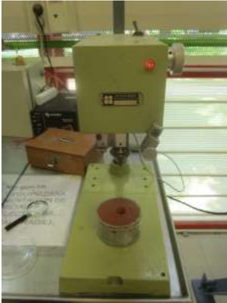
Figura 27. Ensayo de penetración para un contenido de humedad (izquierda) y extracción de una porción de muestra para ser ingresado a la estufa (derecha)
