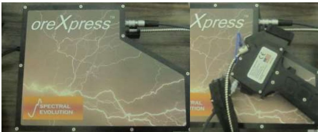
Figura 33. Espectrómetro y sonda de contacto de reflectancia
