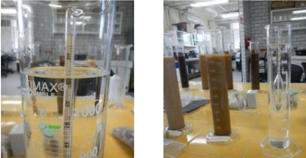
Figura 32. Lecturas de la concentración con el hidrómetro
