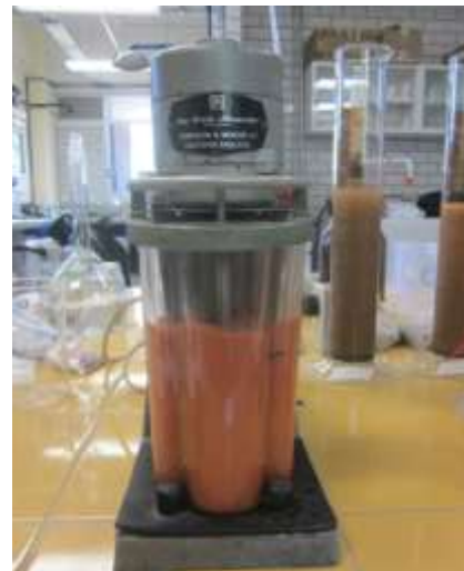
Figura 31. Preparación de las muestras para ser colocadas en las probetas de 1000 ml
