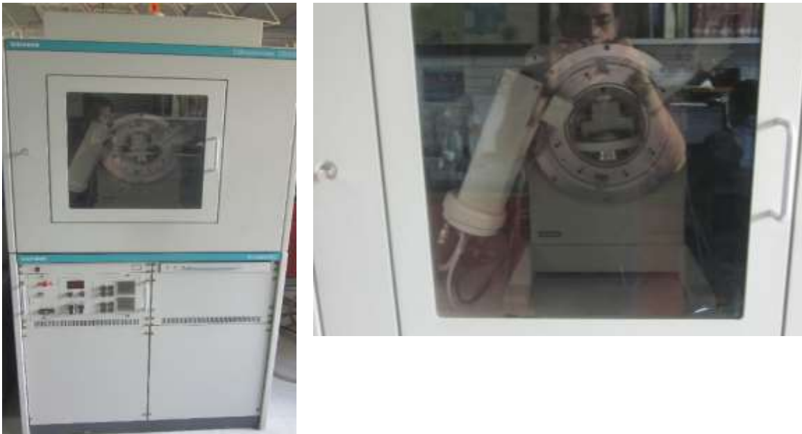
Figura 34. Difractómetro de rayos X Siemens D5000. Particularmente fue utilizado para la identificación de minerales en la superficie de falla que se mantuvo intacta en el flanco derecho del deslizamiento
