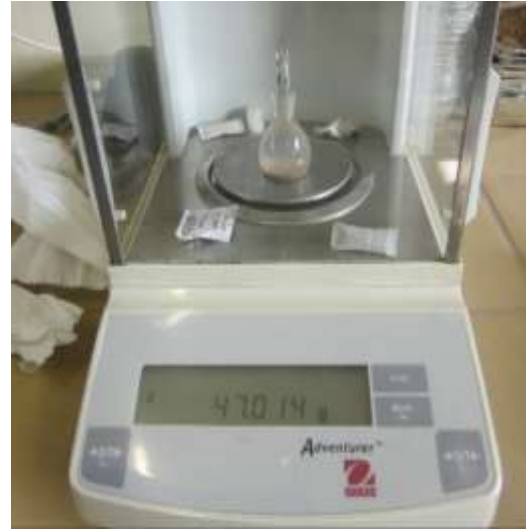
Figura 23. Determinación de la densidad real. Extractor de aire (lado izquierdo) y peso de cada picnómetro con muestra y agua destilada (lado derecho)
