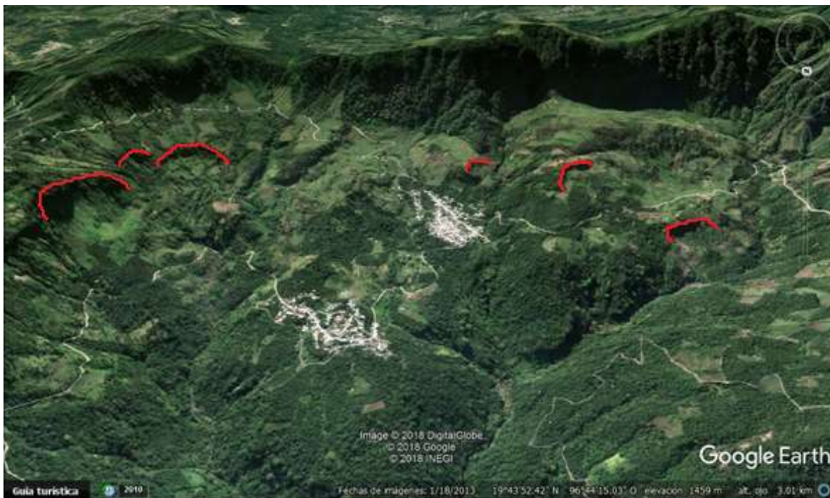
Figura 89. Fotointerpretación en el relieve de deslizamientos en los alrededores del caso de estudio. En la parte superior se observa la comunidad de El Escalanar y en la parte inferior la comunidad de El Capulín
