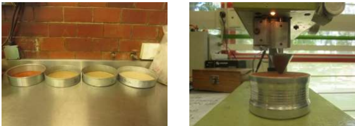
Figura 26. Preparación de las muestras (lado izquierdo) para la ejecución de cada ensayo de penetración con el cono (lado derecho)
