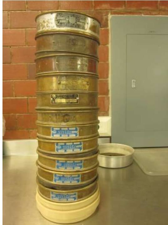
Figura 28. Tamices utilizados para separar las fracciones de gravas (izquierda), arenas y finos (derecha)
