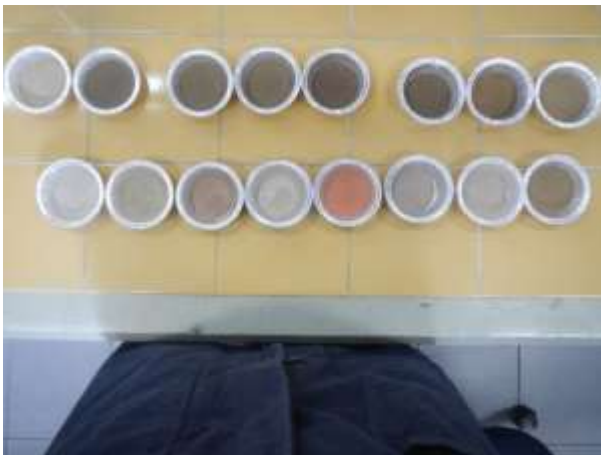
Figura 31. Preparación de las muestras para ser colocadas en las probetas de 1000 ml
