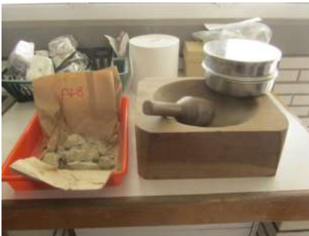
Figura 19. Muestras representativas colocadas en el cuarto de secado para su posterior tamizado, molienda y homogenización
