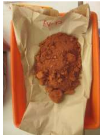
Figura 19. Muestras representativas colocadas en el cuarto de secado para su posterior tamizado, molienda y homogenización
