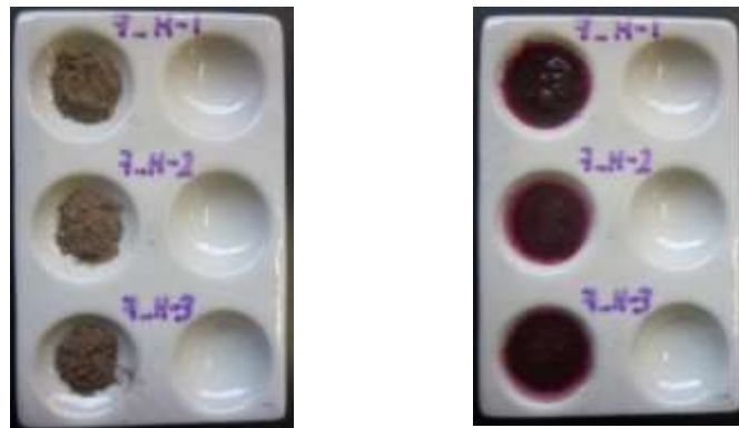
Figura 57. Perfil EV-7 sobre el flanco derecho del deslizamiento para determinar la presencia de aluminio activo. La fotografía de la izquierda muestra una fracción fina de cada muestra y en la derecha la reacción al aluminio activo
