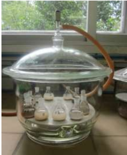
Figura 23. Determinación de la densidad real. Extractor de aire (lado izquierdo) y peso de cada picnómetro con muestra y agua destilada (lado derecho)
