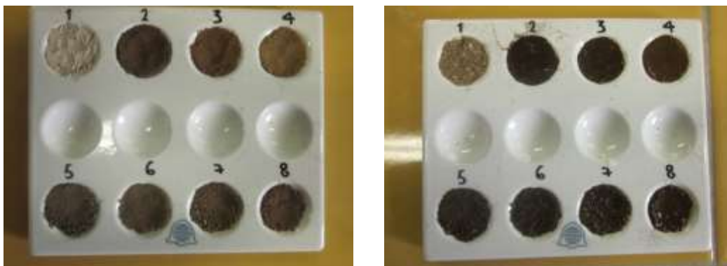
Figura 20. Determinación del color por vía seca (izquierda) y húmeda (derecha). Comparación con Tabla Munsell (2009)
