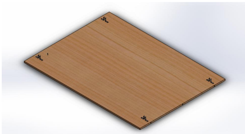
Fig.5.5. Configuración de las escuadras en la base de la cama.
