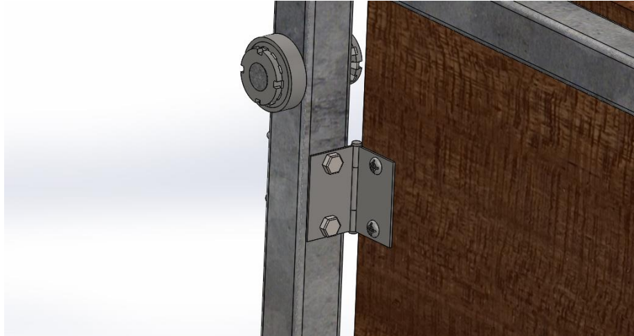
Fig. 5.21. Ensamble de bisagras en el subsistema de puertas móviles.
