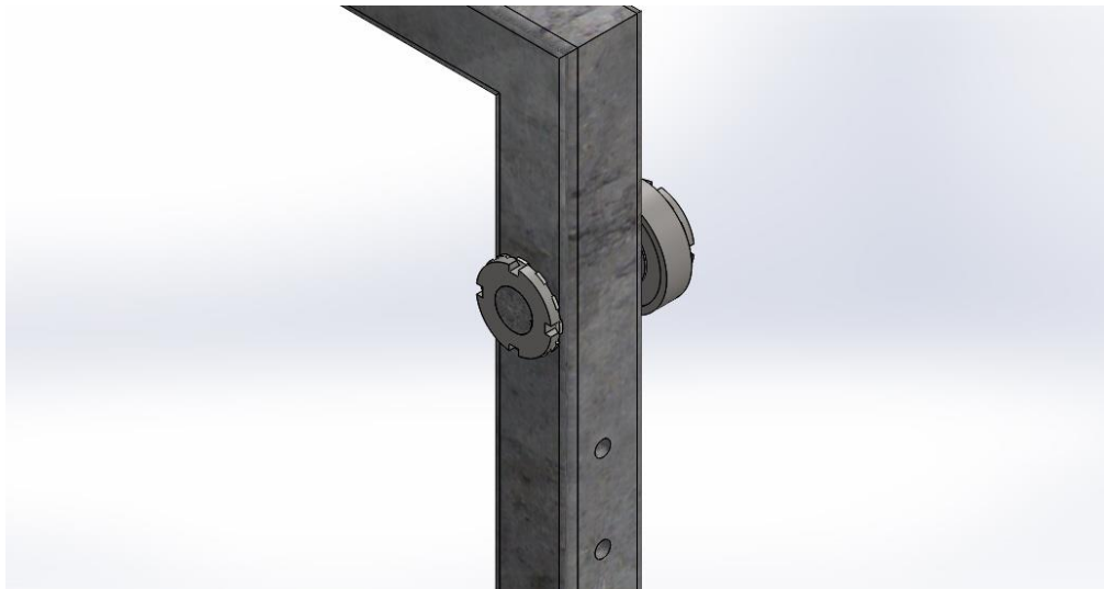
Fig. 5.18. Ensamble de tuercas ranuradas y arandelas de seguridad para la unión de rodamientos.
