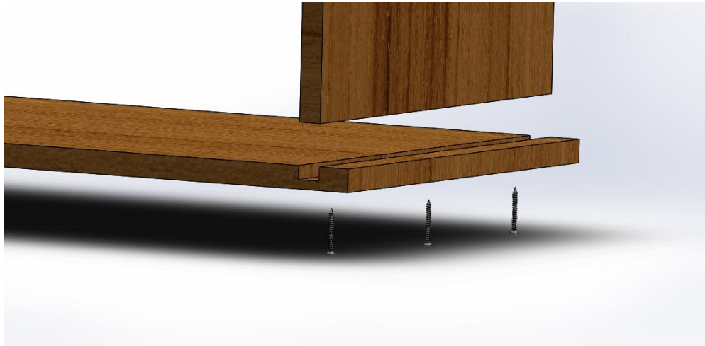
Fig.5.1. Inserción de tornillos inferiores para el ensamblaje del subsistema de marco
