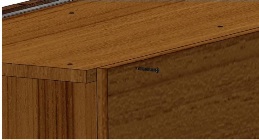
Fig.5.32. Ensamble de la tapa trasera a los subsistemas de camas plegables y repisas.
