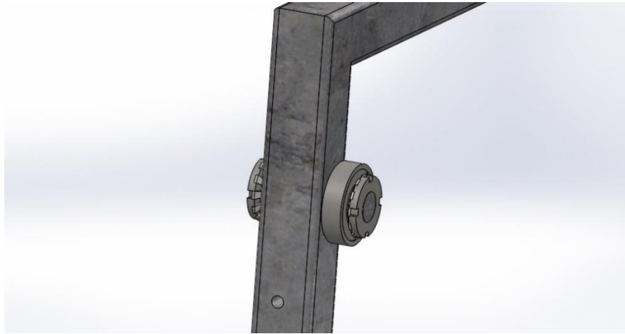
Fig. 5.19. Ensamble de tuercas ranuradas y arandelas de seguridad para la unión de rodamientos.
