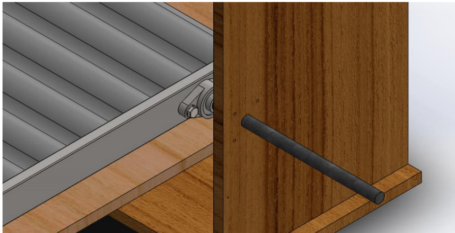
Fig. 5.28. Inserción de la barra de acero para ensamble entre el subsistema de marco y el subsistema de cama plegable.
