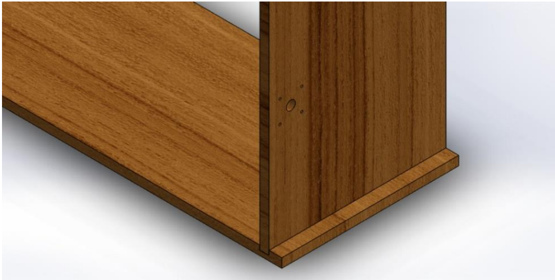
Fig.4.18. Rediseño en el componente horizontal del marco incorporando ranuras.
