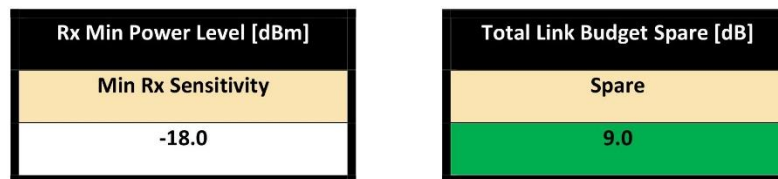
Figura 4. Presupuesto de potencia óptica del enlace
