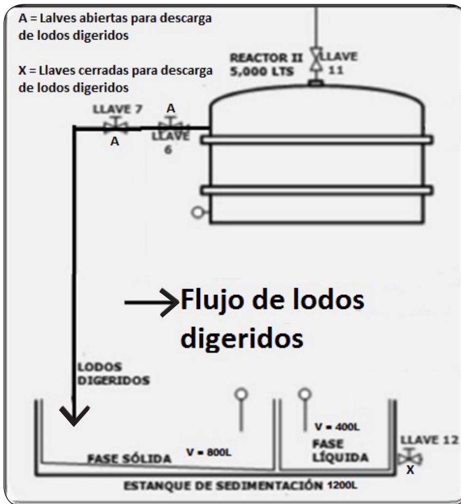
Figura 2.19 Salida de agua y lodos del reactor anaerobio R-II hacia el estanque de lodos y agua
