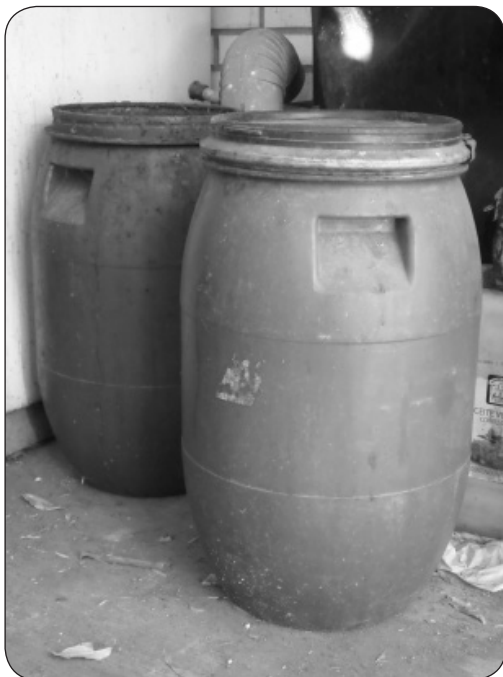
Figura 2.29 Contenedores con cal para controlar pH
