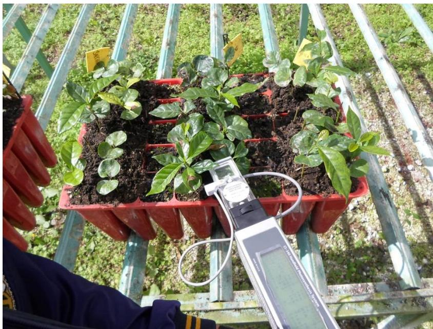
**Figura 9. Medición de radiación fotosintéticamente activa.**
