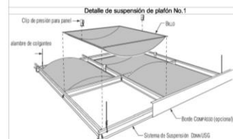
Detalle de suspensión de plafón No.1
