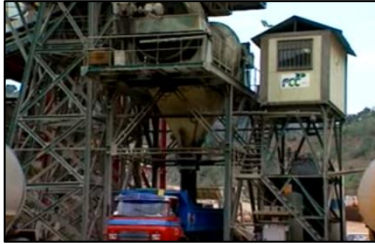
Figura IV.6 Planta de dosificación de concreto utilizada en la presa arco-gravedad Casasola, España. Fuente: (FCC Construcción S.A., 2013)
