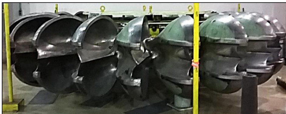
Figura III.13 Turbina Pelton en la casa de máquinas en el P.H. Zimapán.
