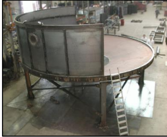
Figura IV.8 Depósito de clarificador de agua fabricado en acero.
