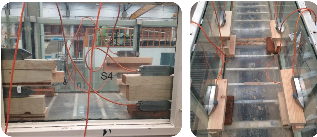
figura 23. Instalación de los sensores en las paredes de canal.
