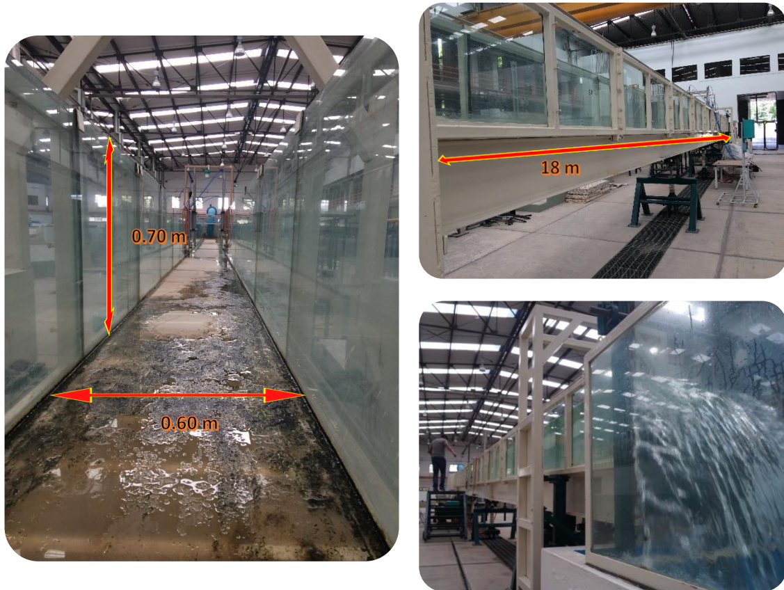
figura 15. Geometría del canal de pendiente variable.
