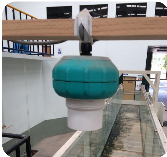
figura 19. Sensor de nivel ultrasónico.
