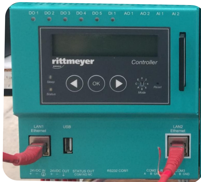
figura 16. Controlador Rittmeyer RISONIC Modular.
