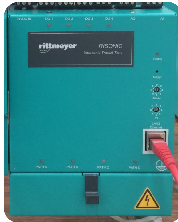
figura 17. Módulo Ultrasonico de Tiempo de Travesía RISONIC Modular.
