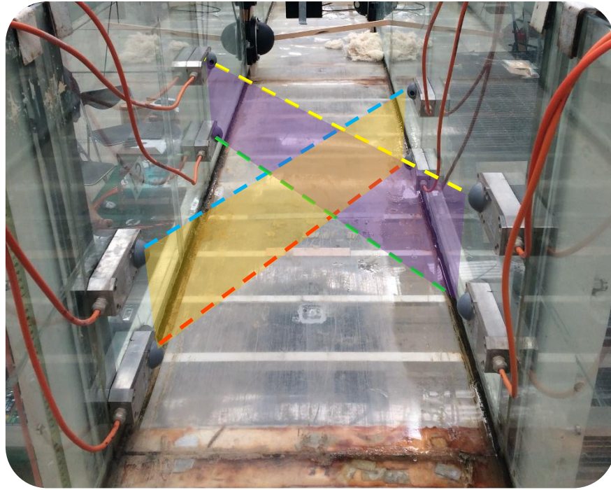
figura 24. Arreglo final de los sensores (2E4P).
