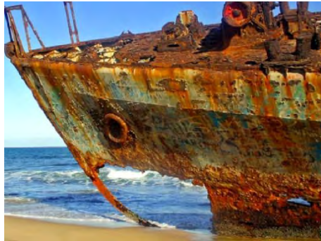
Figura 1. 3 Embarcación deteriorada por corrosión
