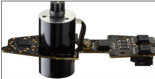
Figura 3.5 Motor del AR Dron 2.0
