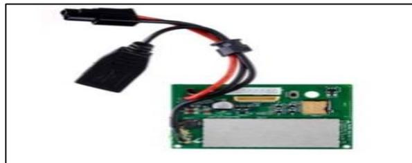
Figura 3.2 Microprocesador del AR Drone 2.0
