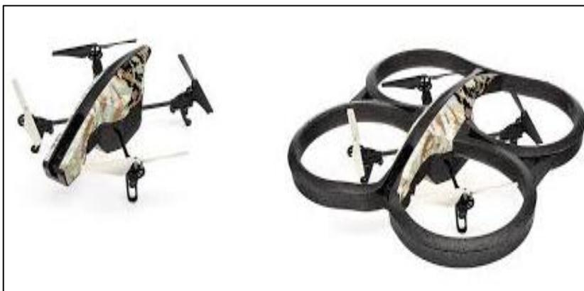
**Figura 3.9 Carcasas del AR Drone 2**
