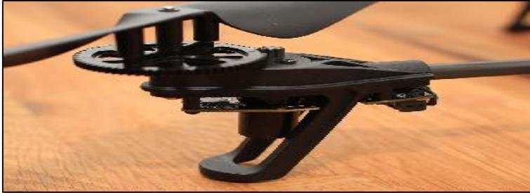
Figura 3.6 Engranajes, soporte y hélice del Ar Drone 2.0
