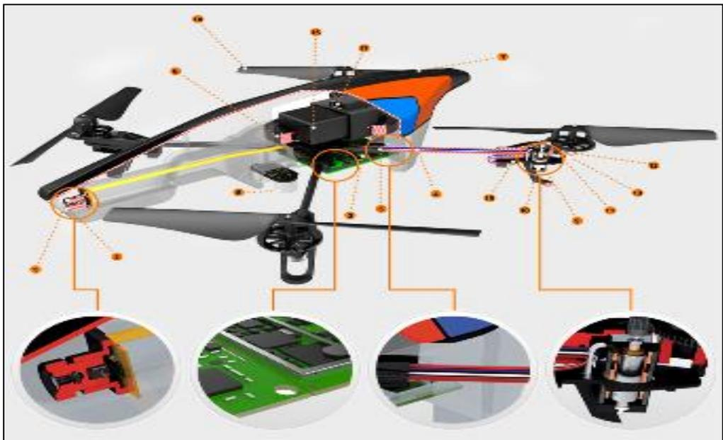
**Figura 3.1 Secciones del AR Drone 2.0**
