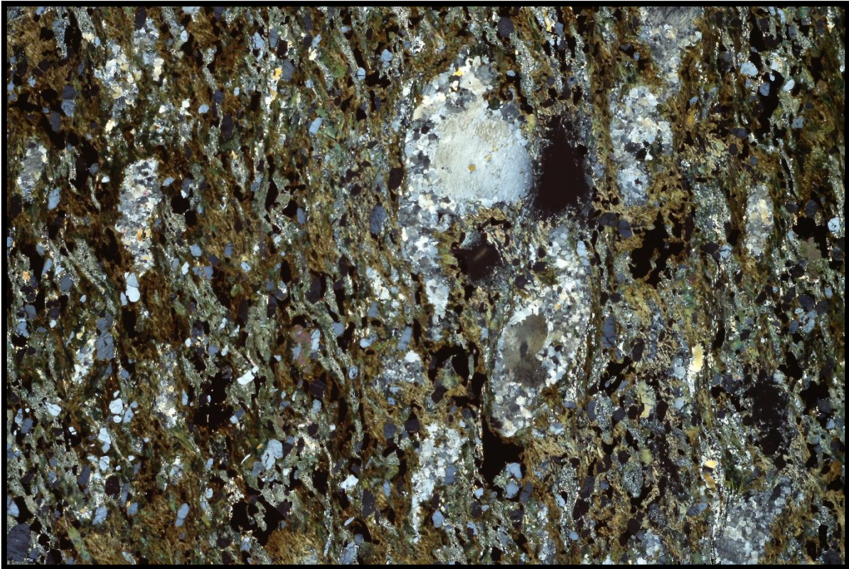
Figura 17. Fotografía en nícoles cruzados de la lámina de una muestra del contacto migmatita-anortosita. Las partes que se observan con coles de interferencia pardos y verdosos son pseudomorfos selvage de biotita y diferentes anfíboles. Asimismo, en la sección media de la fotografía se observan dos pseudomorfos que tienen apariencia de mosaico y en los que hay porfidoblastos relictos de feldespato peritético.
