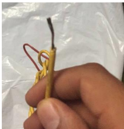
FIGURA 26. COMPOSICIÓN DE CABLE CON UN SOLO AISLANTE Y NÚCLEO METÁLICO
