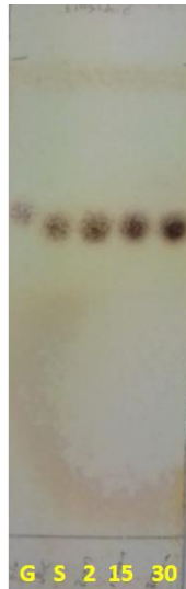
Figura 24. Avance de reacción del inmovilizado PVA-PEG con 10% sacarosa (G:glucosa, S:sacarosa, 2 15 30: tiempo en minutos, Fase móvil butanol:metanol:agua:ac. acético (3:3:1:0.2))
