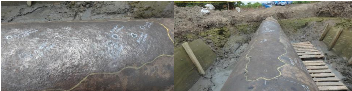
Fotografía 2,3. Aspecto general del dimensionamiento la anomalía 2
