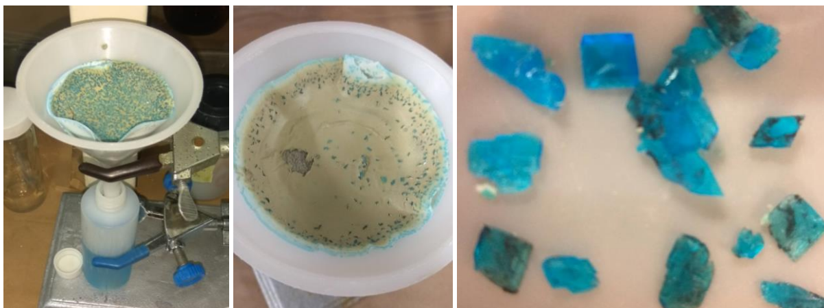
Figura 23 Apariencia de Cristales formados al filtrar el jal ox ac
