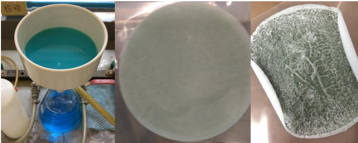
Figura 46 Filtrado y cristalización de precipitado del ácido residual
