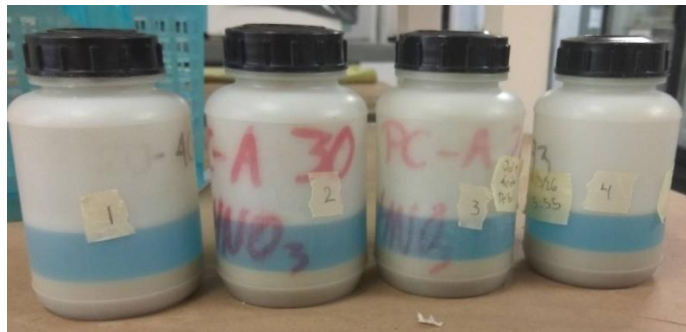
Figura 9 Oxidación del jal con ácido residual
