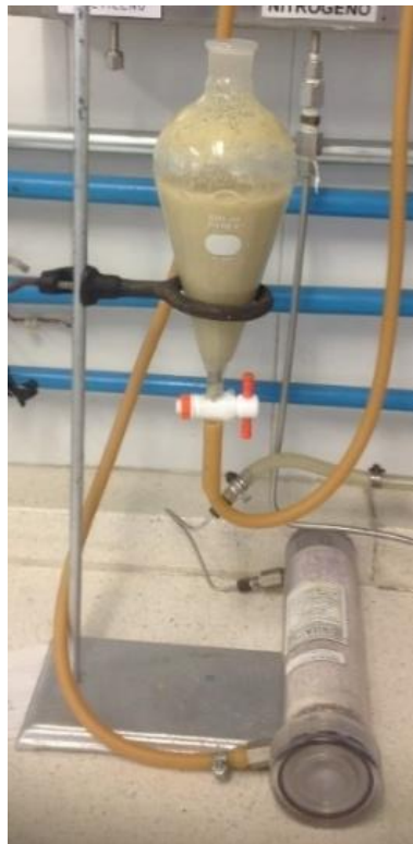
Figura 8 Oxidación del jal con aire
