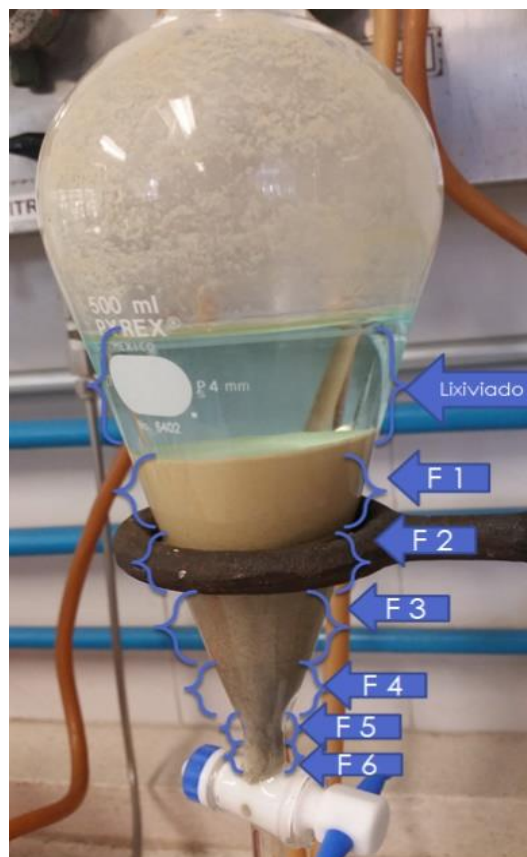
Figura 33 Fracciones de jal separadas por sedimentación
