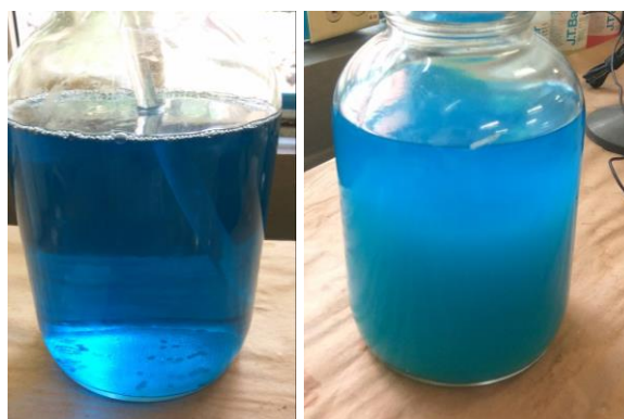
Figura 45 Formación de precipitado del ácido residual a pH 1
