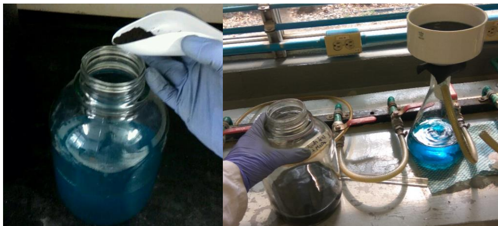
Figura 10 Oxidación con MnO_2 y filtrado del ácido residual
