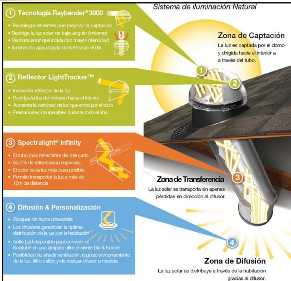
Imagen 34: Funcionamiento de un sistema de iluminación natural.
