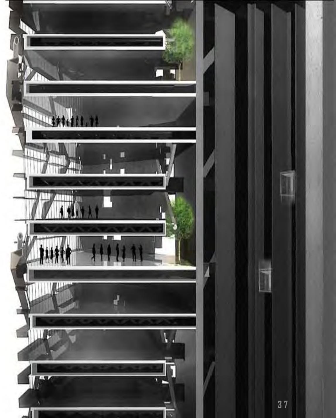
Torre Reforma se organiza en 14 clusters cada uno de 4 pisos. Ya que la Ciudad de México cuenta con actividad sísmica frecuente, los muros de concreto fueron diseñados para tener movimiento debido a sus aberturas de triple altura, las cuales ayudan a disipar la energía sísmica. Las aberturas se repiten cada cluster y proporcionan luz natural a los jardines interiores.
