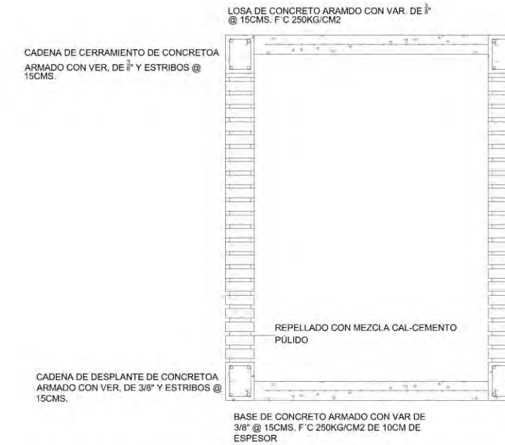
DETALLE DE BASE DE TRANSFORMADOR
