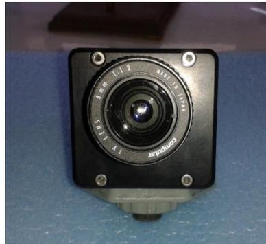
Ilustración 4-9 Cámara MotionScope monocromática.
