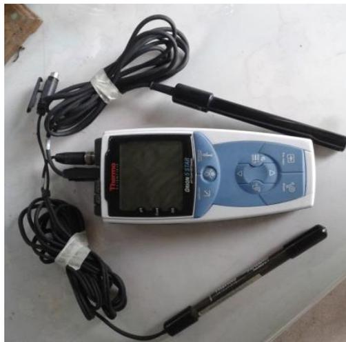
**Ilustración 4-6 Conductímetro 5star**
