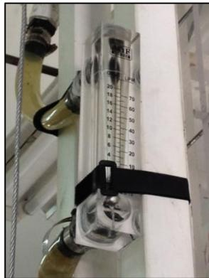
**Ilustración 4-8 Rotámetro Capacidad 75 l/min**
