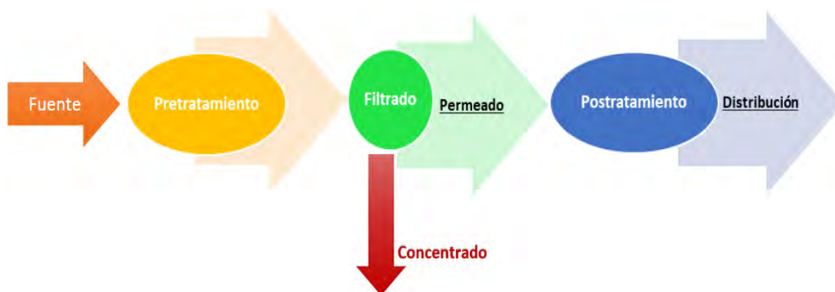
Figura 3.4. Diagrama simplificado del funcionamiento de una planta de ósmosis inversa
