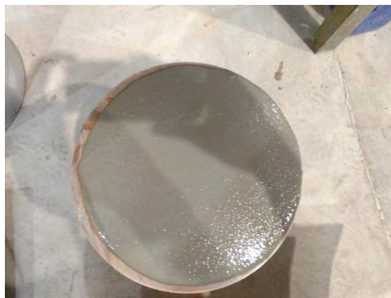
Figura 3.14. Prueba de fluidez en mortero de relleno.
