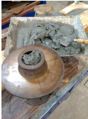
Figura 3.13. Mesa de fluidez con platillo de bronce y cono trunco.
