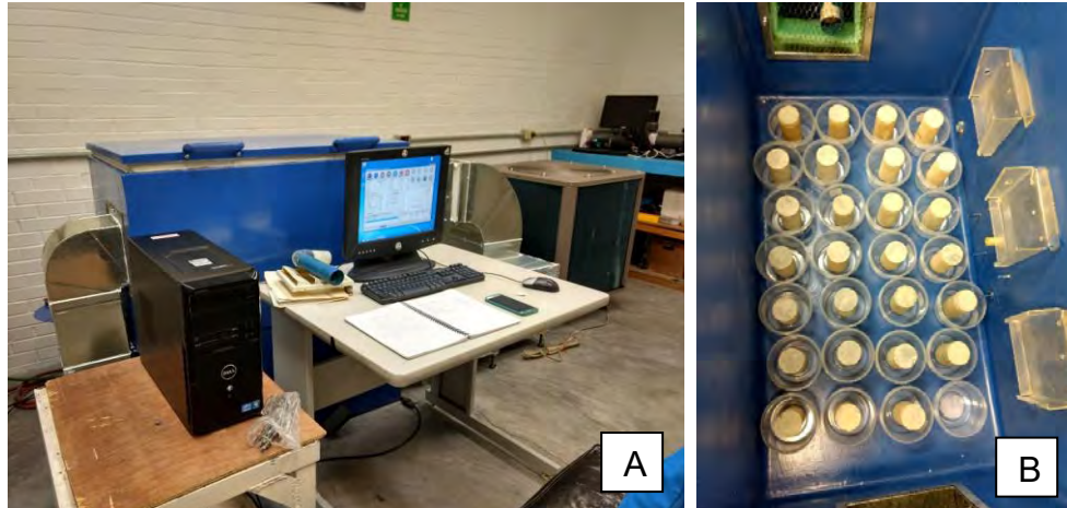
Figura 3.16. Cámara de intemperismo acelerado (A). Especímenes en cámara de intemperismo acelerado (B).
