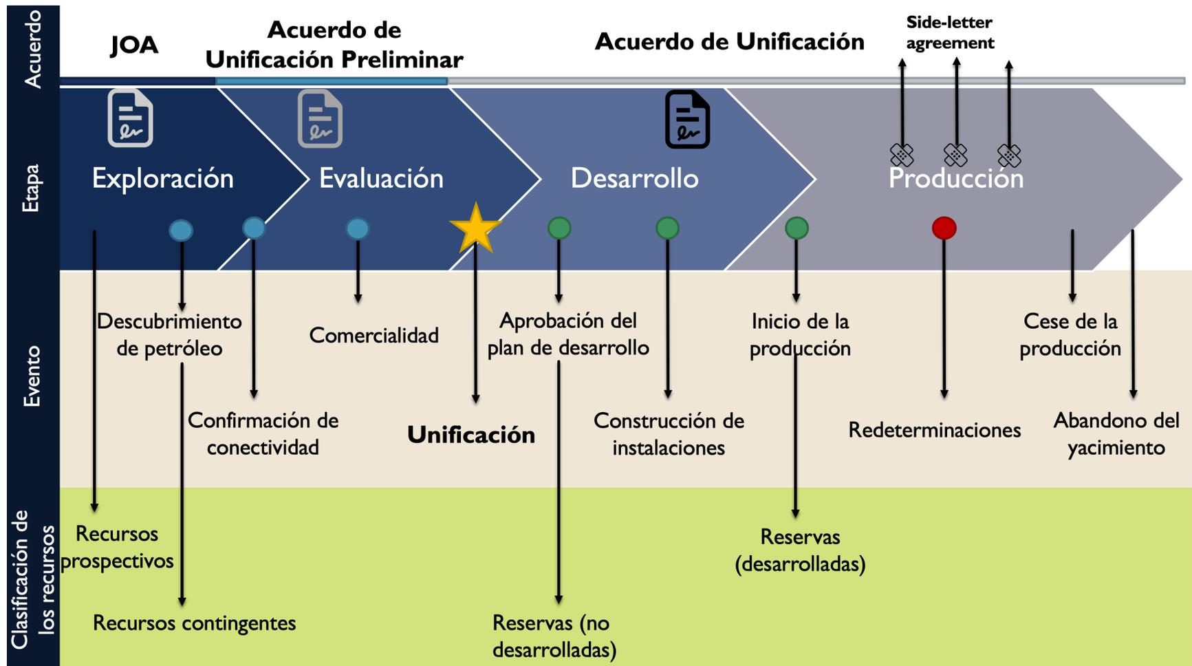
FIGURA 15. ESQUEMA DEL PROCESO DE UNIFICACIÓN (MODIFICADO DE WORTHINGTON, 2016).
