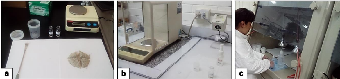
Fotografía 2. a) Las muestras pulverizadas son cuarteadas para homogenizar sus componentes, se pesó 120 g. de cada muestra que fueron colocados en bombas de teflón limpios y etiquetados. b) Las bombas de teflón con las muestras se les agrega el spike (Sr - Sm - Nd IGL) señalado. c) Las bombas de teflón con las muestras son puestas en la campana de extracción para enseguida colocar agua MQ, \text{HClO}_4 y HF de acuerdo con el procedimiento.
