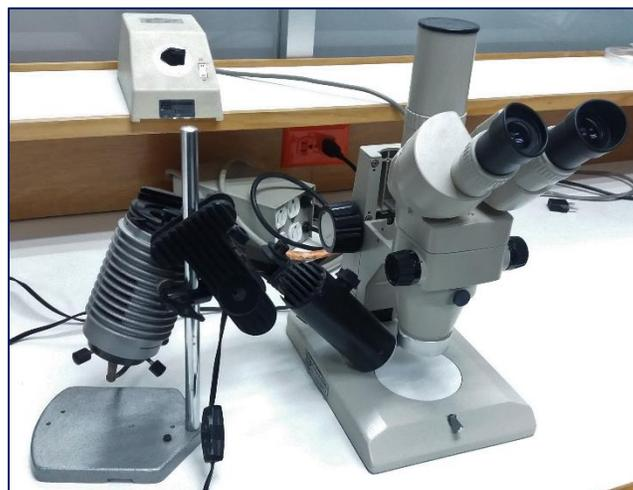
Figura 5.5. Microscopio binocular.
