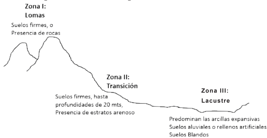
Imagen 41: Zonificación estratigráfica en la Ciudad de México. Fuente : Reglamento de Construcciones del Distrito Federal.
