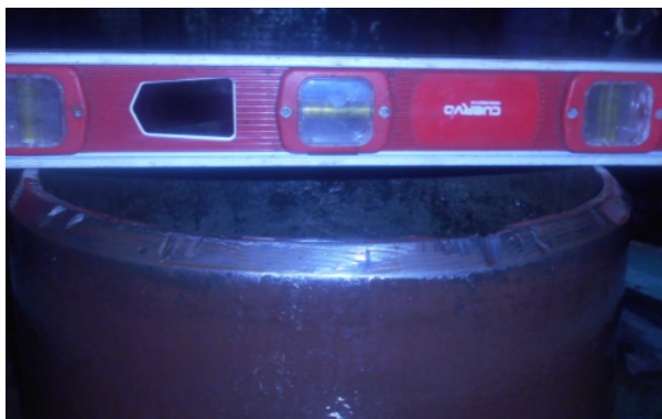
Figura 4.7: Alineación de la espiga de la TR durante cambio de cabezales.
