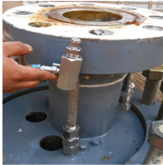
Figura 3.11: Tornillo de terminación presentado en bonete.
