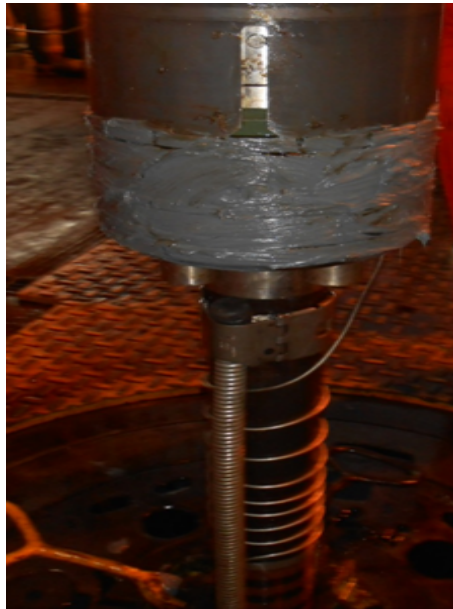
Figura 4.8: Línea de control para la válvula de tormenta enrollada como reserva por debajo del colgador.
