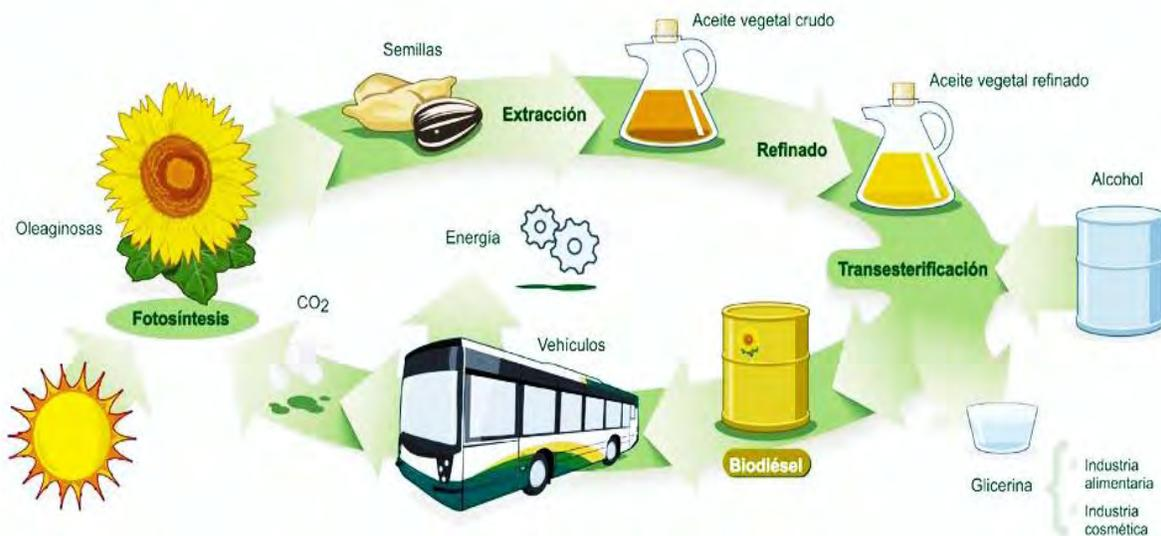
Figura 1.4. Ciclo del biodiésel en el cual se parte de la biomasa para obtener aceites o grasas que son sometidas a la reacción de transesterificación para obtener biodiésel y glicerol, el biodiésel es usado en motores, posteriormente este genera energía y CO<sub>2</sub>, este último es usado por las plantas, cerrándose así el ciclo [15].
