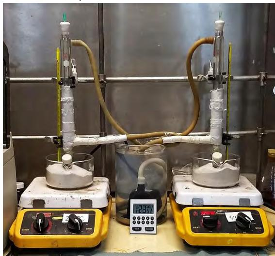
Figura 3.10. Montaje del sistema para la reacción de transesterificación.
