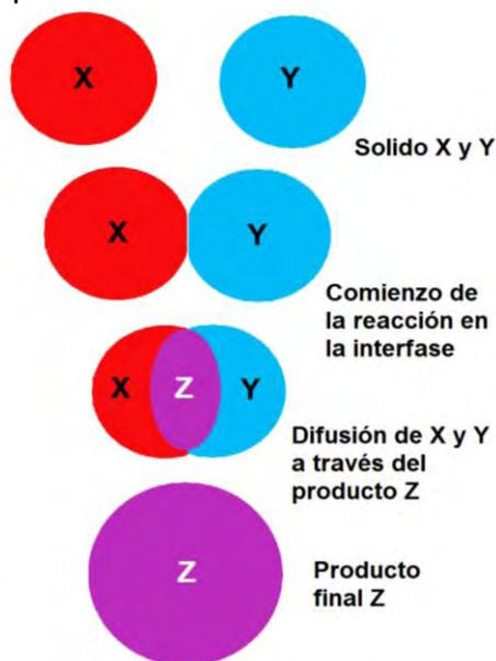
Figura 1.11. Reacción por química del estado sólido, en donde se observa el proceso de nucleación [24].
