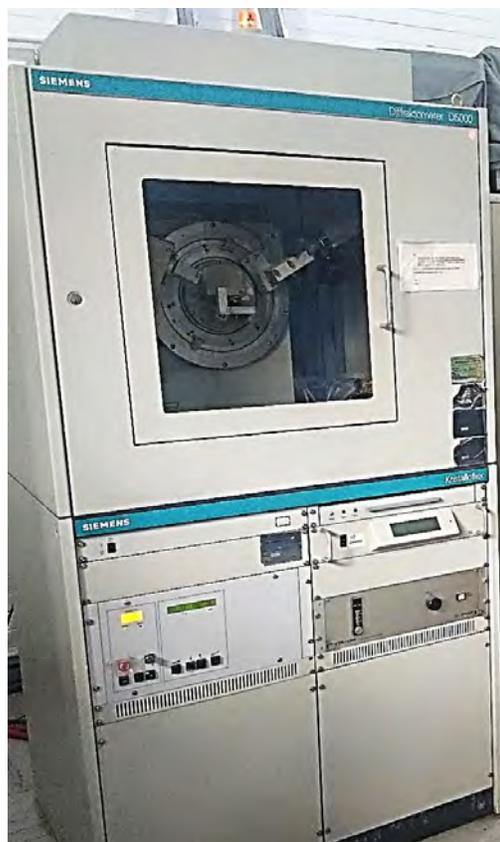
Figura 3.3. Difractómetro de rayos X Siemens D5000.
