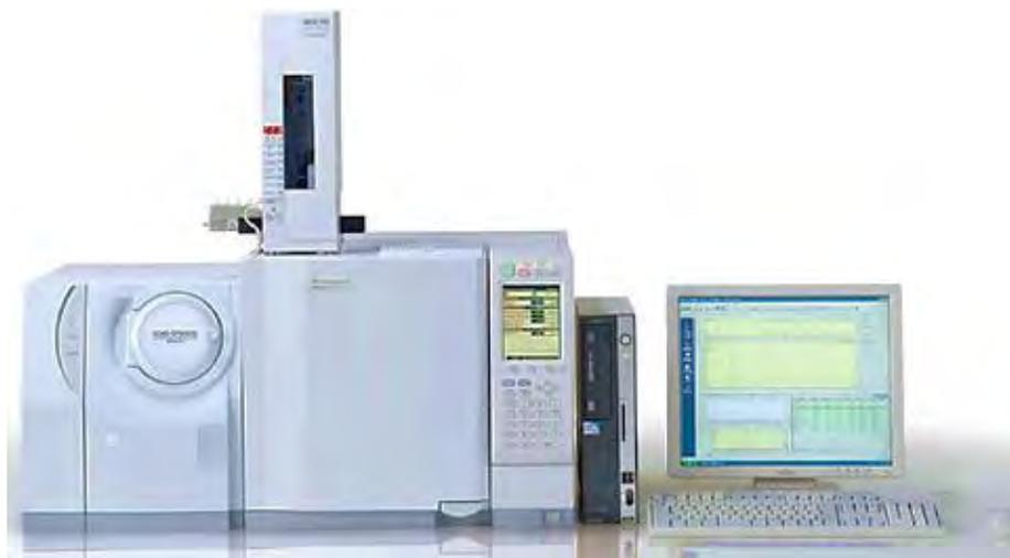
Figura 3.16. Cromatógrafo de gases acoplado a espectrometría de masas SHIMADZU GCMS-QP2010.
