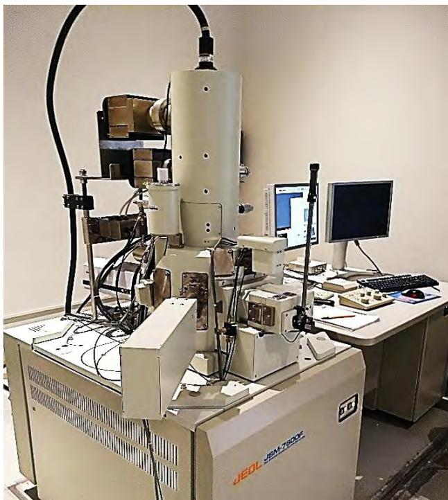
Figura 3.5. Microscopio electrónico de barrido JEOL JSM-7600F.
