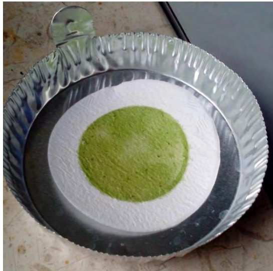
Figura 7.8 Filtro Whatman con biomasa seca.
