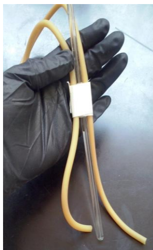
Figura 5. Mangueras de hule fijas a la varillas de vidrio
