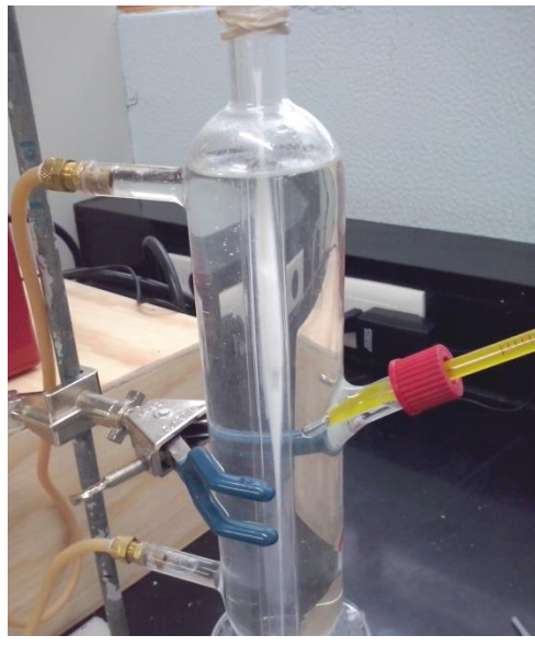
Figura 10. Supositorio muestra completamente fundido.
