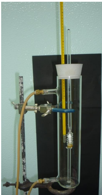
Figura 7. Canastilla y termómetro dentro del Aparato.
