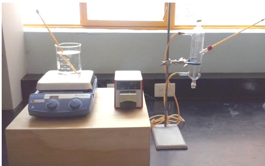
Figura 4. Orden de la parrilla, bomba peristáltica y aparato para medir el tiempo de licuefacción.
