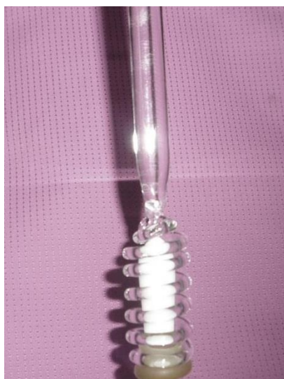
Figura 6. Supositorio muestra dentro de la canastilla de vidrio.
