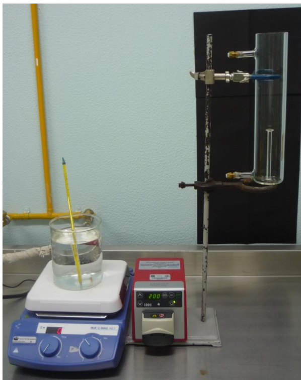
Figura 3. Orden de la parrilla, la bomba peristáltica y el aparato
