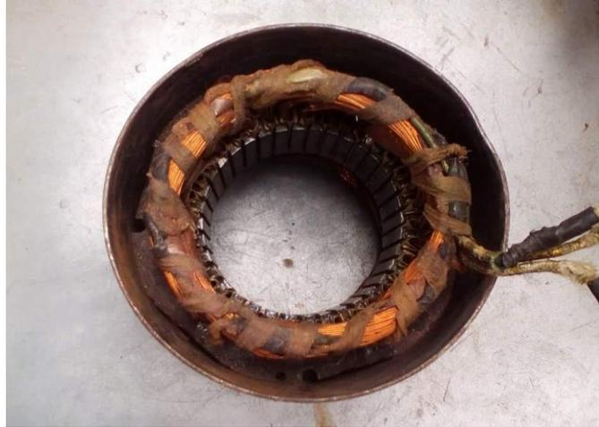
*Figura 39. Vista frontal del estator. (Elaboración Propia)*
