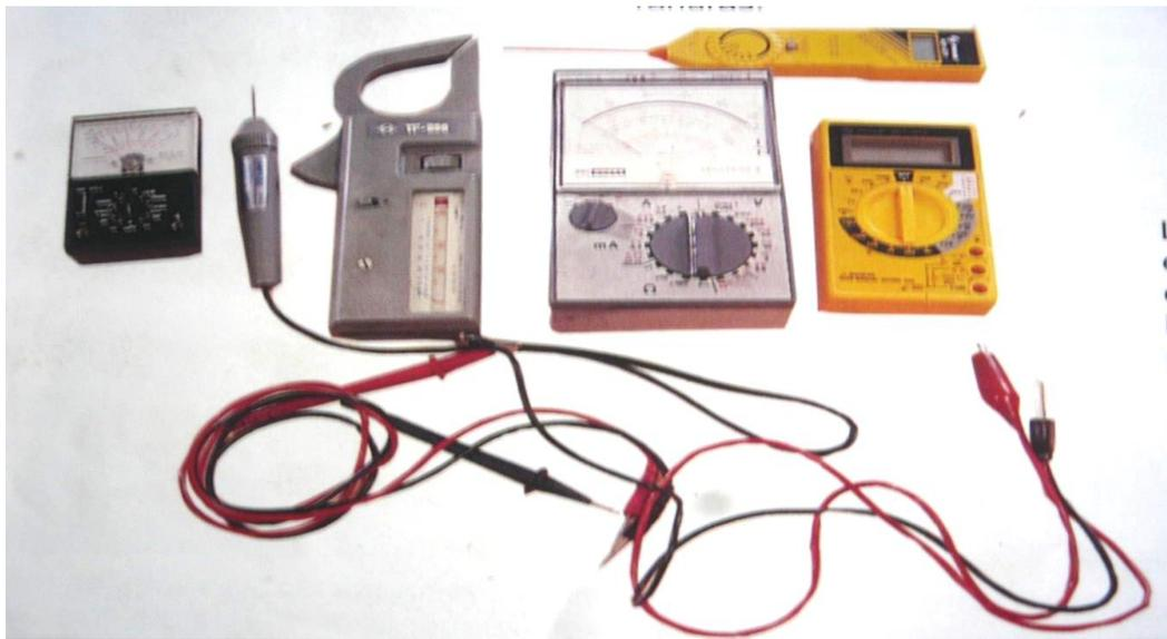
**Figura 19. Herramientas propias del oficio de un técnico en mantenimiento de motores eléctricos.** Lesur L. (1998) *Manual de Embobinado de Motores C. P. 09439, México D. F.*
