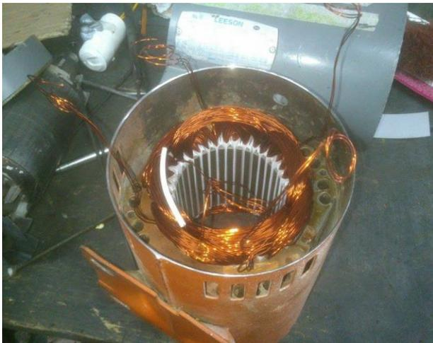
***Figura 22. Vista de las bobinas de arranque y trabajo. (Elaboración propia)***
