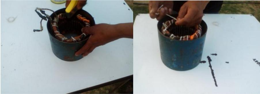
**Figura 40. Amarrado y embarnizado del bobinado.** (Elaboración Propia)
