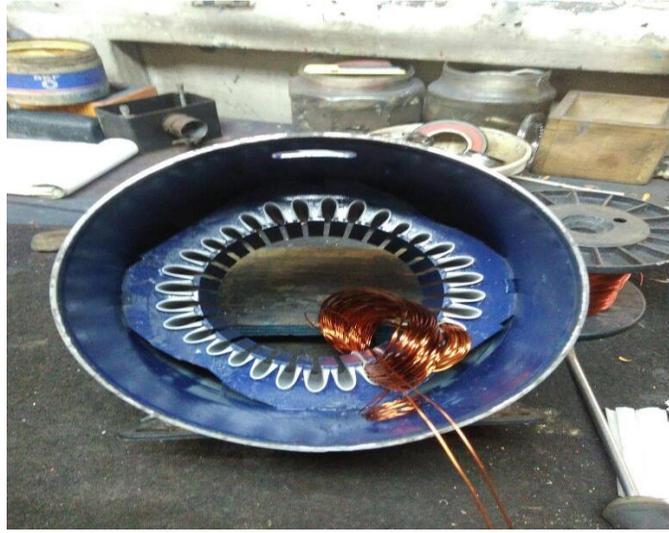
***Figura 27. Colocación de la primera bobina. (Elaboración propia)***
