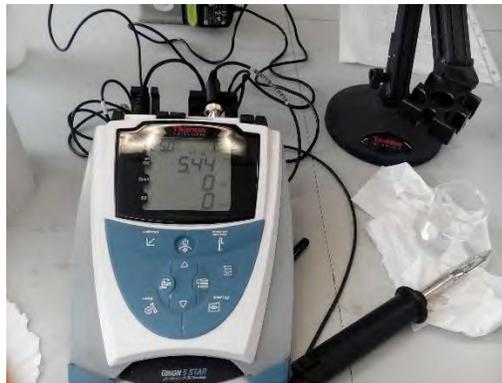
**Figura 18. Potenciómetro de Orion 5-star**
