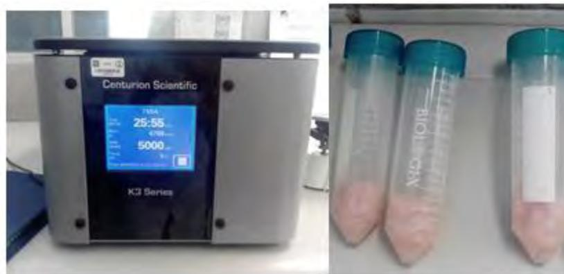
**Figura 19. Prueba de centrifugación para la determinación de CRA en muestras refrigeradas**
