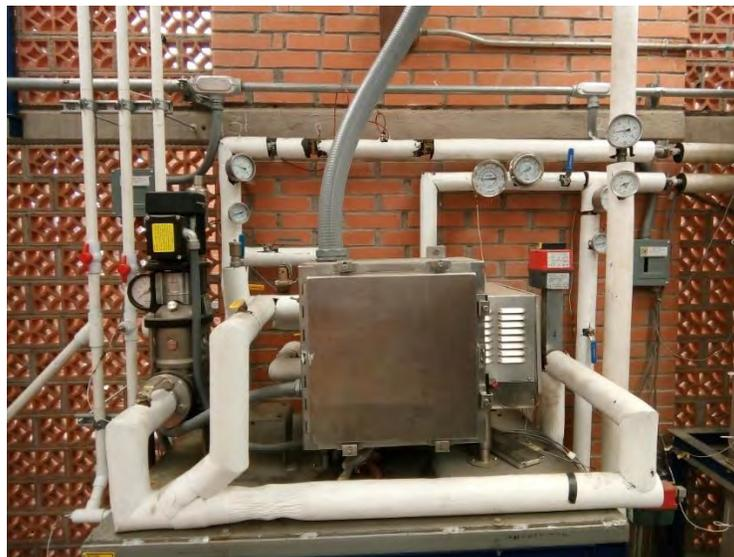
**Figura 4.13 Módulo de resistencia eléctrica y controlador de temperatura**
