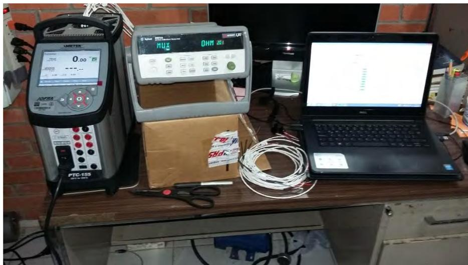
**Ilustración 3 Calibrador, adquisidor de datos y computadora durante calibración de los RTD's**
