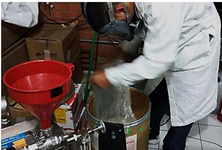
**Ilustración 16** Proceso de triturado del nitrato de litio, previo a su deshidratación
