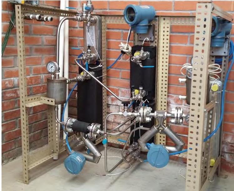
**Ilustración 11 Montaje e interconexión de componentes del equipo de enfriamiento**
