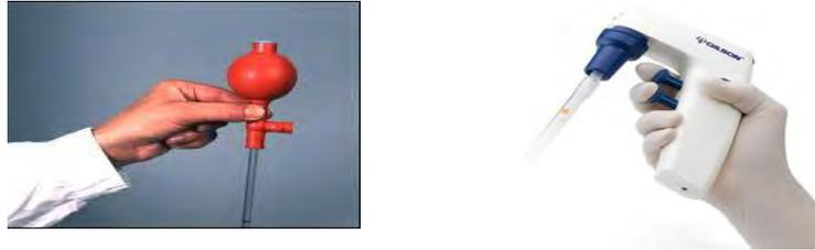
**Figura 35.** Dispositivos de pipeteo. La figura del lado izquierdo corresponde a un bulbo de seguridad de tres vías y el del lado derecho a un pipeteador automático. Imagen recuperada el 4 de septiembre de 2017 de: <http://karollagorditagmail.blogspot.com/2011/03/uso-de-material-en-el-laboratorio-de.html>
