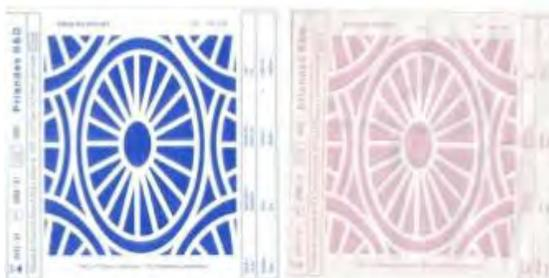
**Figura 42.** Test de Bowie Dick - Clase II. En la figura se muestra el color azul como color inicial y el vire a color rosa homogéneo corresponde a un ciclo terminado correctamente. Imagen recuperada el 8 de septiembre de 2017 de: [http://www.surgiplast.com.co/g\\_productos/g\\_indicadores/test\\_bowie\\_&\\_dick.jpg](http://www.surgiplast.com.co/g_productos/g_indicadores/test_bowie_&_dick.jpg)
