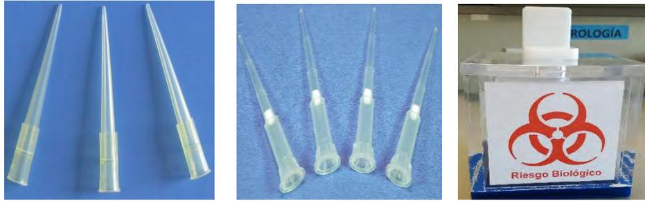
**Figura 40.** Puntas para micropipeta. En la imagen de la izquierda se presentan puntas sin filtro, en la imagen central se observan puntas con filtro y en la imagen de la derecha se observa un contenedor de acrílico para depositar las puntas usadas por las micropipetas.
