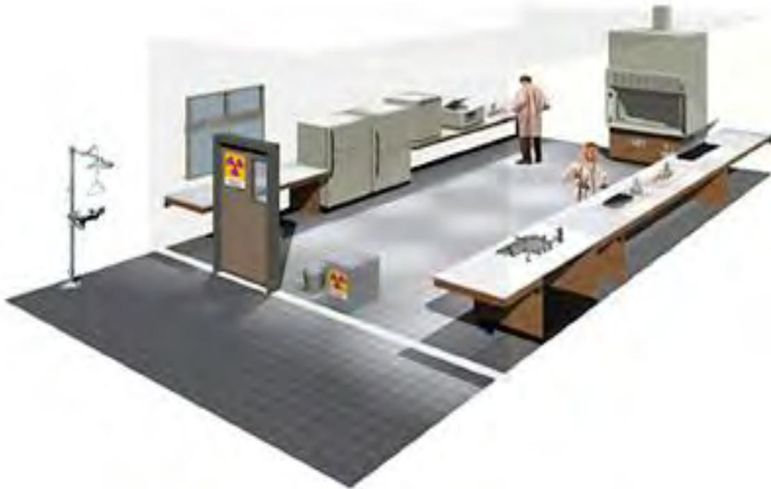
**Figura 2.** Laboratorio de bioseguridad nivel 1. En la imagen se observa una campana de extracción, una mesa de trabajo, equipo de cadena fría y el personal utiliza bata de algodón. No se coloca en la entrada el logotipo de riesgo biológico (Imagen cedida por CUH2A, Princeton, NJ (EE.UU)).
