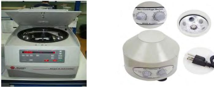
**Figura 36.** Tipos de centrifuga. La imagen del lado izquierdo representa a una centrifuga clínica refrigerada de mesa y la imagen del lado derecho corresponde a una microcentrifuga. Imagen recuperada el 5 de septiembre de 2017 de: <http://www.directindustry.es/prod/eppendorf/product-22548-867125.html>
