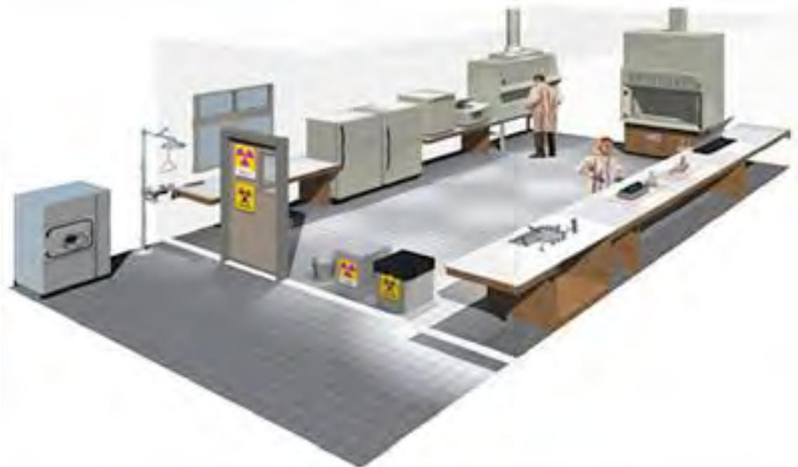
**Figura 3.** Laboratorio de bioseguridad nivel 2 Los procedimientos que pueden generar aerosoles se efectúan dentro de una cabina de seguridad biológica. Las puertas se mantienen cerradas y llevan el logotipo de riesgo biológico. Los residuos potencialmente contaminados se separan en RPBI. Imagen cedida por CUH2A, Princeton, NJ (EE.UU).
