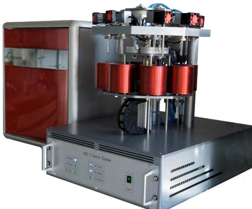
Figura 3.3. Analizador Elemental vario MICRO cube acoplado a grafitizador AGE III.
