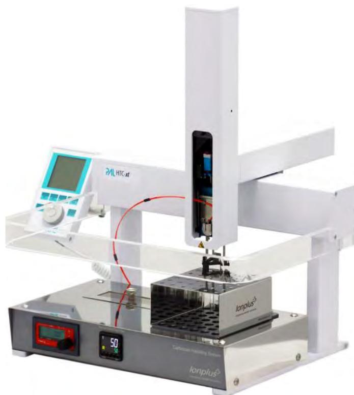
Figura 3.4. Sistema de manejo de carbonatos y muestreador automático.
