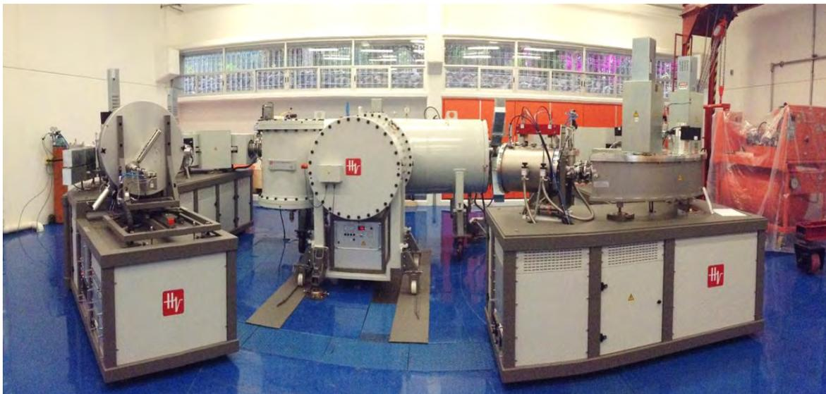
Figura 3.6. Separador isotópico con acelerador tipo tándem de 1MV.
