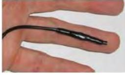
Termistor que detecta la temperatura de la superficie de la piel entre 10°- 45°, convirtiéndola en una señal eléctrica.
