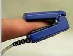
Dispositivo de dedal, que registra los cambios de volumen sanguíneo a nivel local, mediante la emisión de una señal luminosa para después transmitir dicha señal a una computadora (cambios en la amplitud de onda pulso), para conocer si existe o no disfunción endotelial, a través del software “Adquisición 7.2” desarrollado por el Instituto Nacional de Cardiología Ignacio Chávez.
