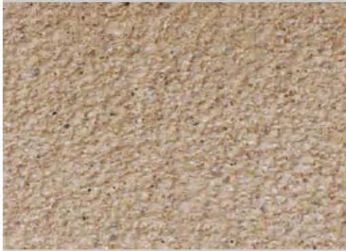
Concreto lavado color ocre
