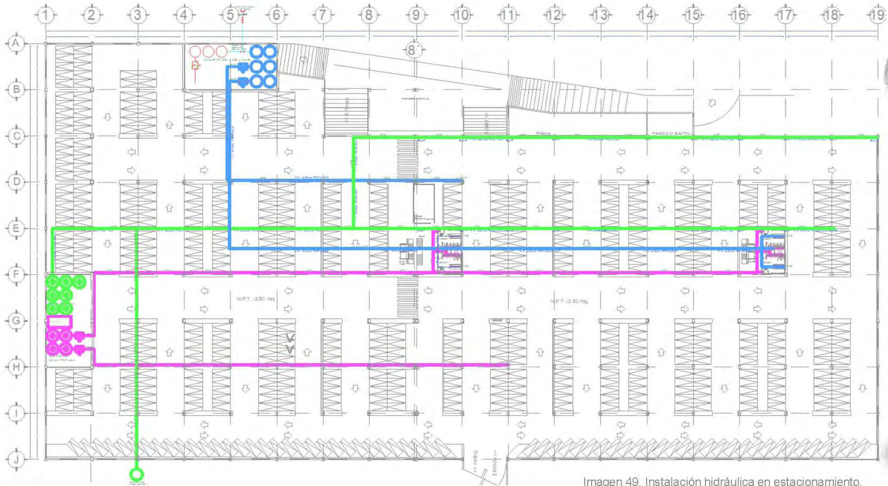
Imagen 49. Instalación hidráulica en estacionamiento.
