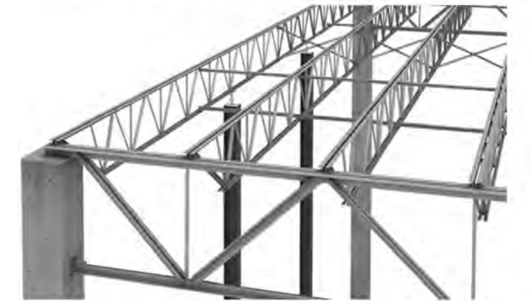
Fuente de imagen: Google. sistema constructivo JOISTEC.
