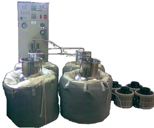
Equipo de limpieza con mantillas de calentamiento y recóstatos
