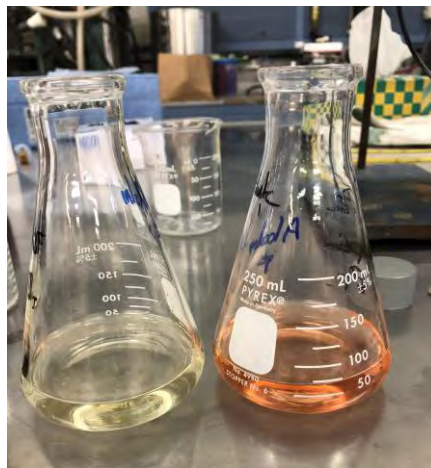
Figura 25.- Determinación de alcalinidad por cambio de color de amarillo a naranja mediante titulación de \text{H}_2\text{SO}_4 .
