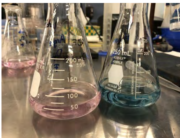
Figura 24.- Determinación de dureza total por cambio de color de rosa a azul mediante titulación de EDTA.
