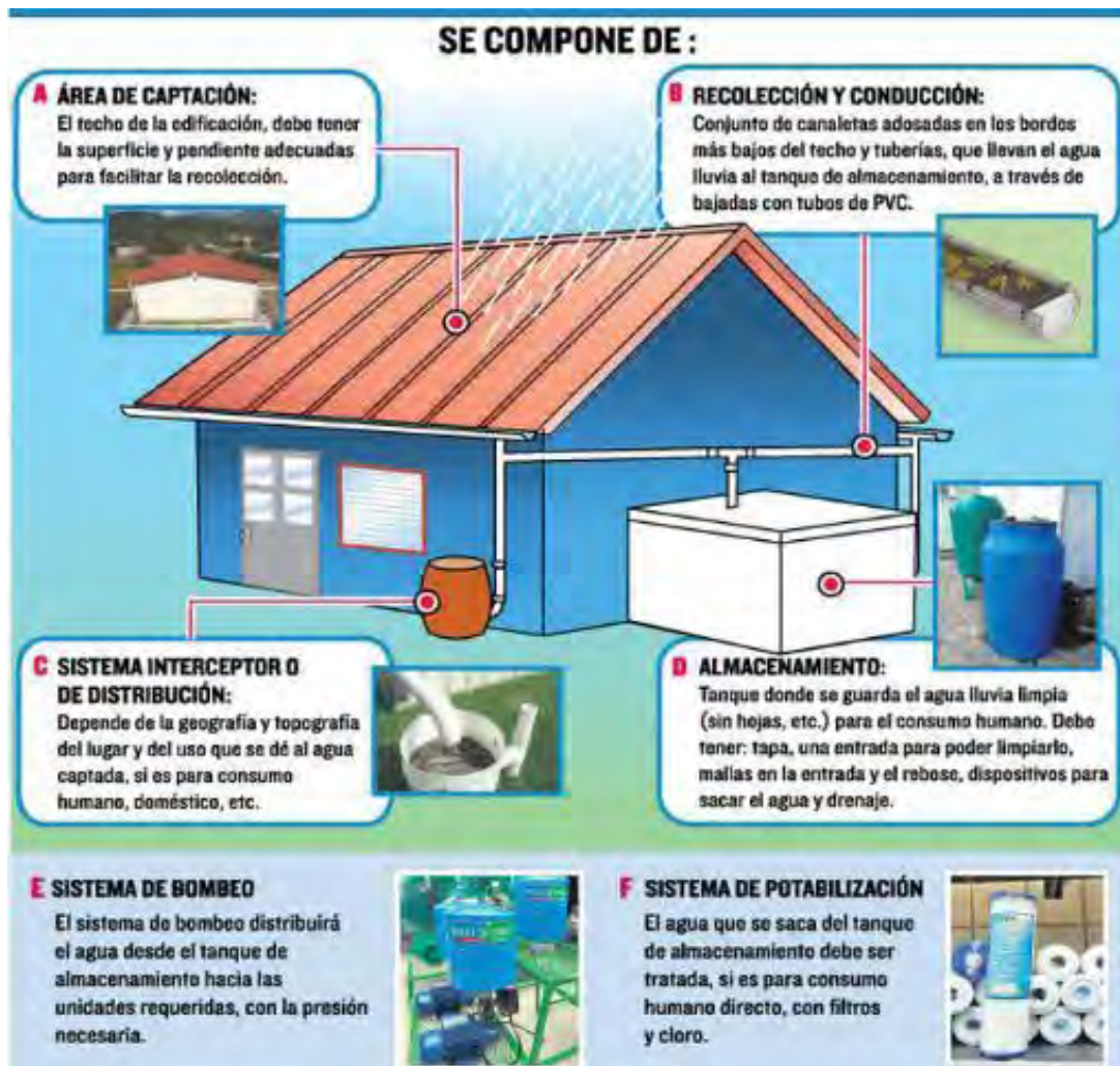
Figura 7.- Diagrama de los componentes de un SCALL. Fuente: Organización Panamericana de la Salud, 2010.
