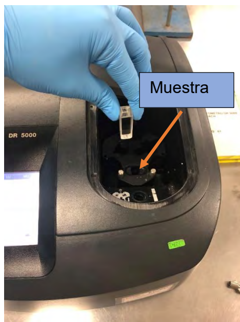
Figura 20.- Espectrofotómetro DR 5000 para la determinación de absorbancia UV y color de las muestras recuperadas de la AMC.
