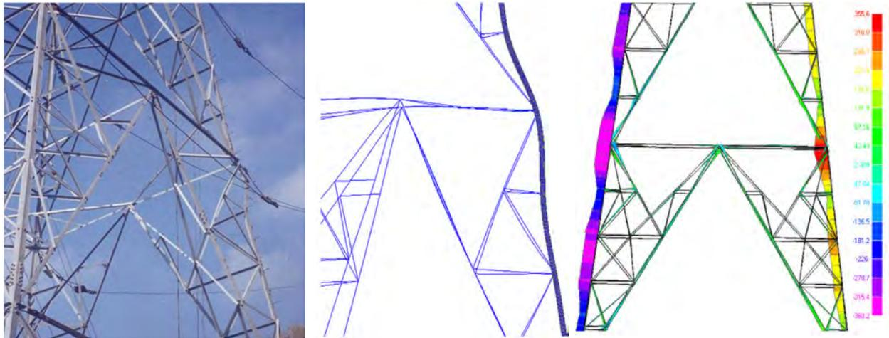
Figura 7.6 Falla por pandeo en elemento principal de torre (piernas), (Rao, et al., 2010)
