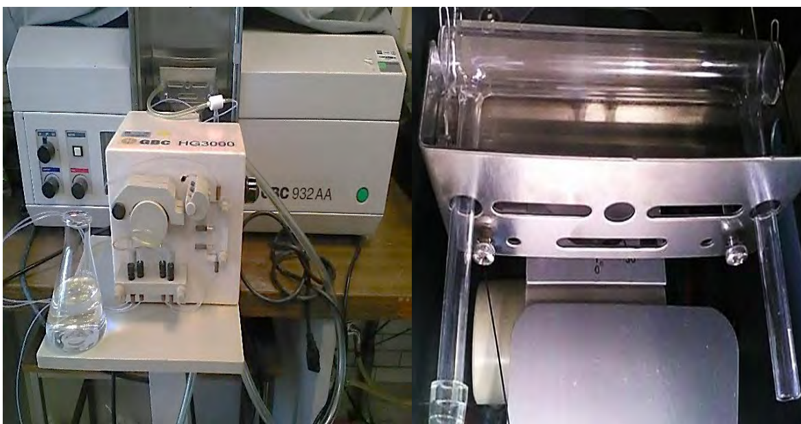
Figura 14. EAA-GH y lámpara de cátodo hueco (realizado por Méndez-González, 2017)
