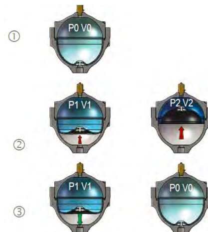
Figura 2.11: Variaciones de P y V en el acumulador Fuente [Hidroleduc, 2018]
