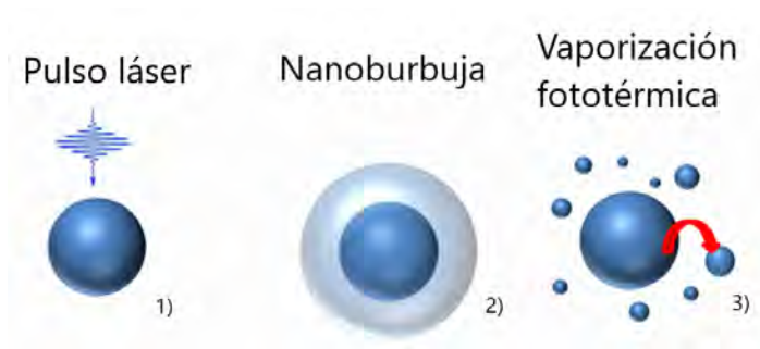
Figura 1.9: Esquema del mecanismo de vaporización fototérmica. Adaptado de [3].
