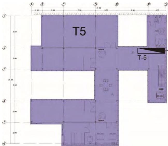
Fig. 143. Zonificación por tableros. Segundo nivel, tablero: T5.
