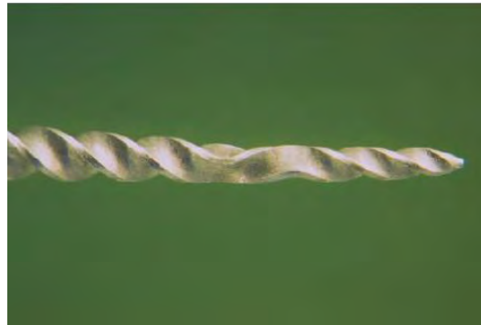
Fig. 5 Deformación elástica de una lima rotatoria de NiTi
