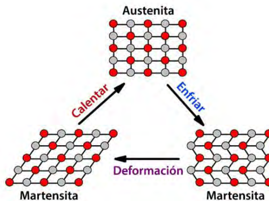
Fig. 6 Fases cristalográficas del NiTi
