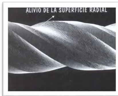
Fig. 15 Alivio de la superficie radial
