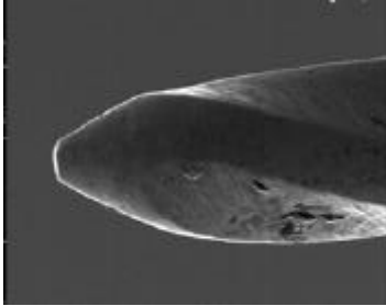
Fig. 21 Instrumento con electropulido
